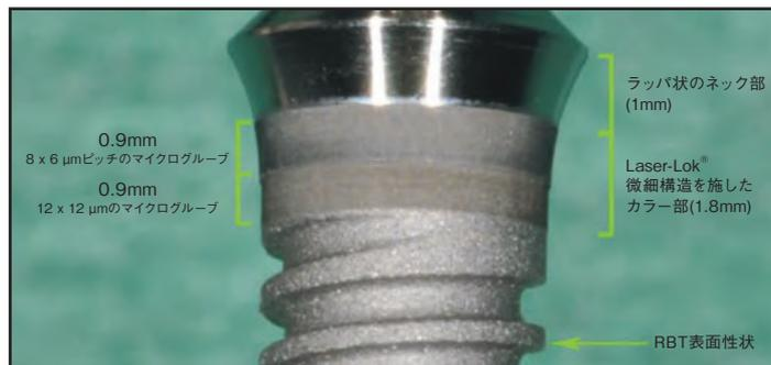
図1: Single-stage インプラントシステム
